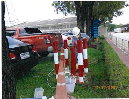
ภาพที่ 2-5 บ่อตรวจวัดคุณภาพน้ำใต้ดินของพื้นที่ TPE Site1
